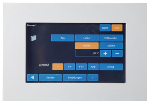
Interface utilisateur "chauffer" de la commande Diamant pour vérandas.
