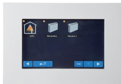
Sélection des appareils connectés. Ici, dans l'exemple, le chauffage Diamant et l'éclairage.
