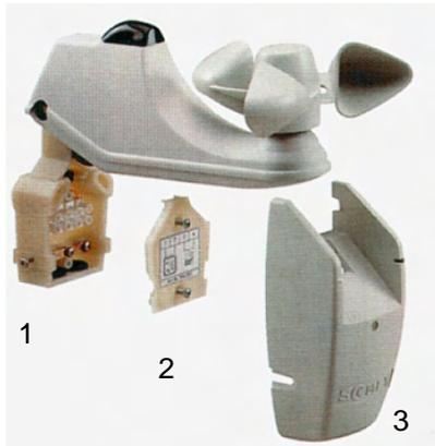
Bild 9: Montagereihenfolge für die Wetterstation
